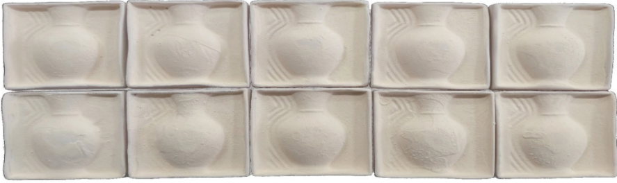
Görsel 2: Üleksit yerine Atık 1 kullanılan sır deneme plakaları (soldan sağa 1D AT1U 1-10 sıralı) (Kaynak: Yazar Arşivi).
