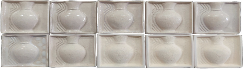
Görsel 4: Kuvars ve kil yerine Atık 1 kullanılan sır deneme plakaları (soldan sağa 1DAT1KK 1-10 sıralı) (Kaynak: Yazarların arşivi)
