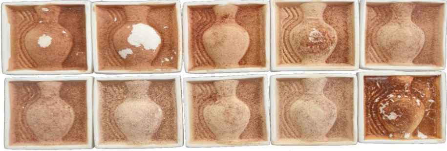
Görsel 3: Üleksit yerine Atık 2 kullanılan sır deneme plakaları (soldan sağa 1DAT2U 1-10 sıralı) (Kaynak: Yazar Arşivi).
