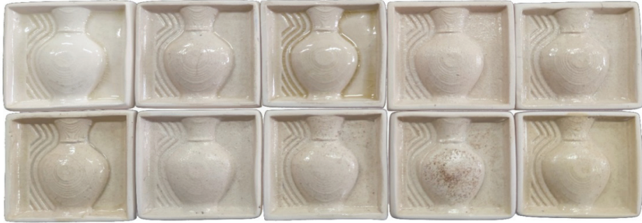
Görsel 7: Sodyum ve potasyum feldispat yerine Atık 2 kullanılan sır deneme plakaları (soldan sağa 1D AT2F 1-10 sıralı) (Kaynak: Yazar Arşivi).
