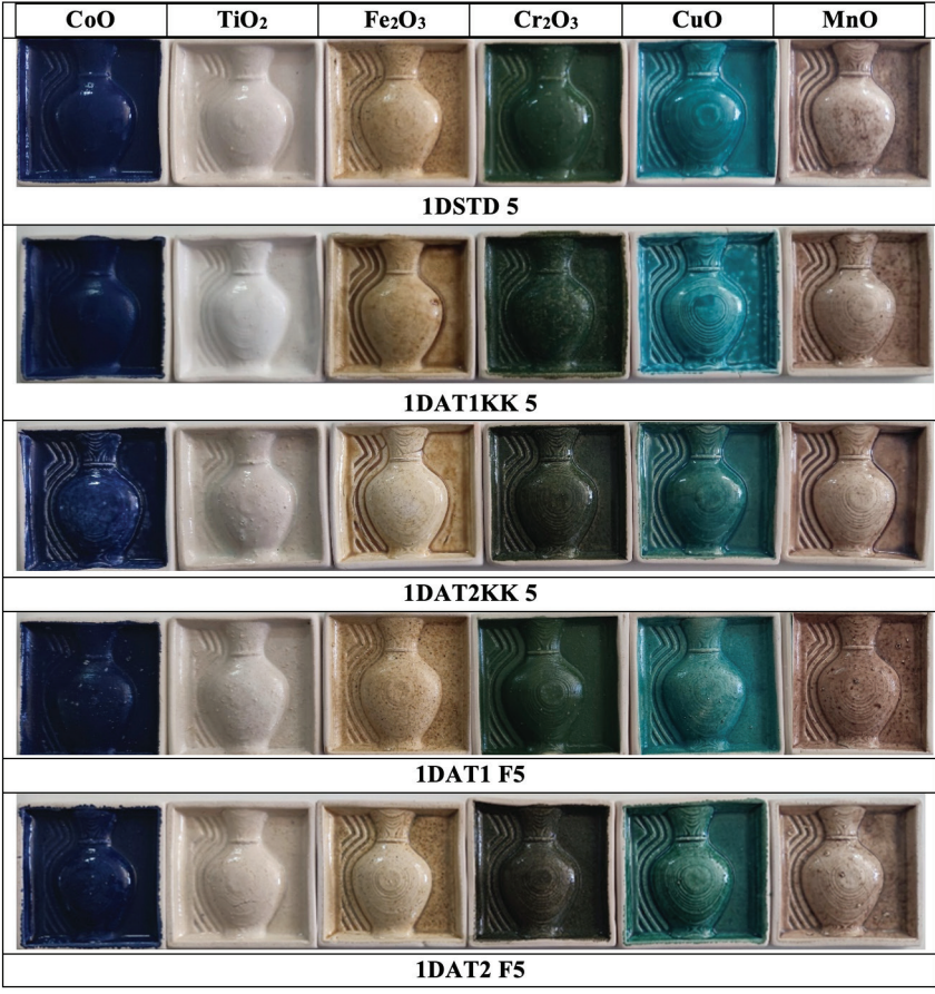
Görsel 9: Renklendirme için seçilen standart (STD), Atık1 (Borojips) ve Atık2 (Konsantratör) katkılı sırların 1000 C 0 sıcaklıkta pişirim sonrası renklendirme sonuçları (Kaynak: Yazar Arşivi).
