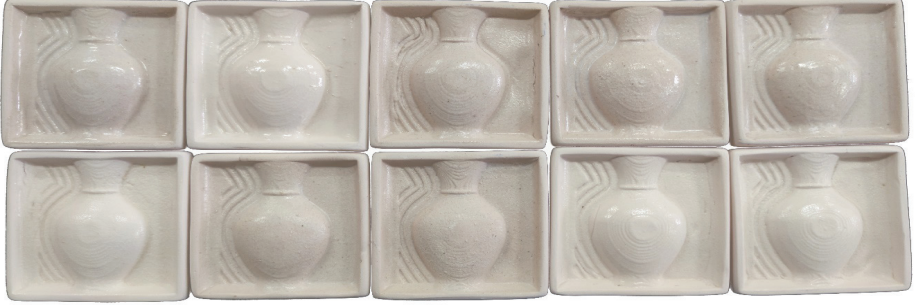
Görsel 6: Sodyum ve potasyum feldispat yerine Atık 1 kullanılarak hazırlanan sır deneme plakaları (soldan sağa 1D AT1F 1-10 sıralı) (Kaynak: Yazar Arşivi).
