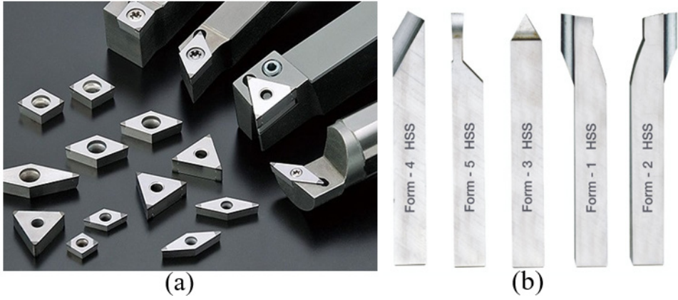
Şekil 2. Torna kesici takımı a) değiştirilebilir kesici uç, b) yekpare kalem
